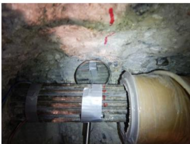
Zkušební místo EM3 - detail umístění Hallových sond
