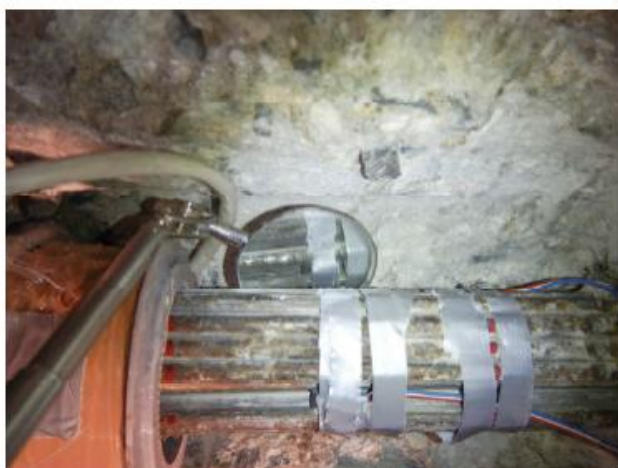
Zkušební místo EM4 - detail umístění Hallových sond
