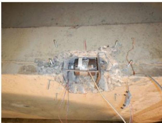
Zkušební místo EM3 - instalovaný EM snímač, kompletní
