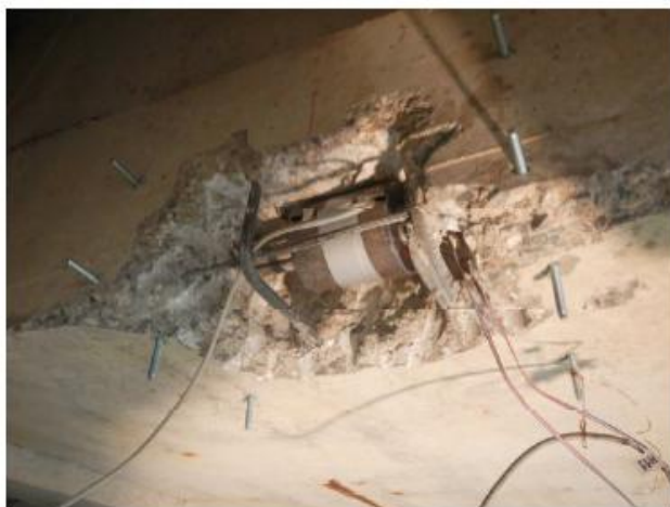
Zkušební místo EM4 - instalovaný EM snímač, kompletní
