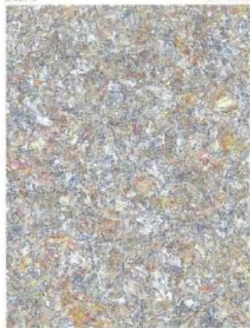
Obr. 8 – Část protokolu zkoušení mikrostruktury vzorku předpínacího lana
